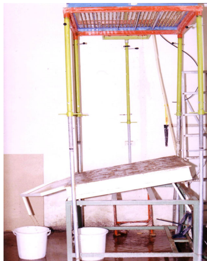
شکل (۱): شمای دستگاه شبیه ساز مورد استفاده در آزمایش
