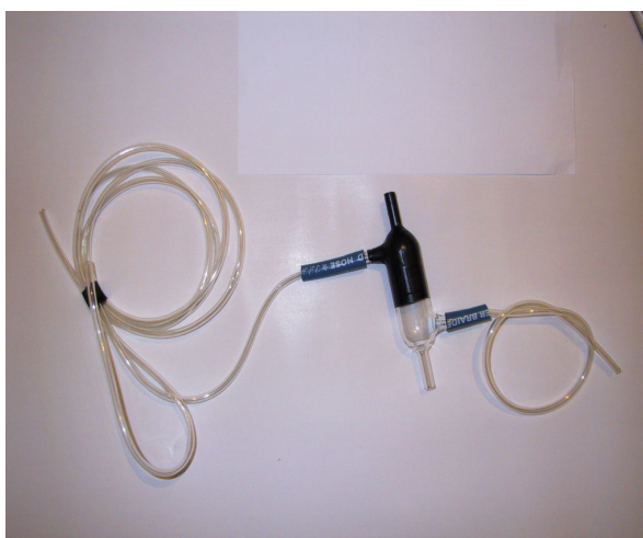
شکل ۳ - تیوب با چهار مجرا: دو مجرا برای قرارگیری حسگرها و دو مجرا برای ورود و خروج دود
