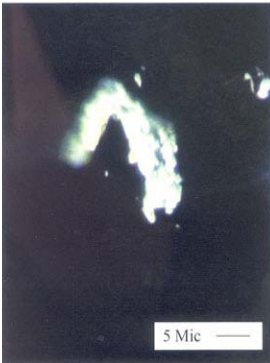
تصویر 22- طلای آزاد در داخل باطله سیلیسی در نمونه‌های به شدت دگرسان شده (سیلیسی، سولفیدی).
