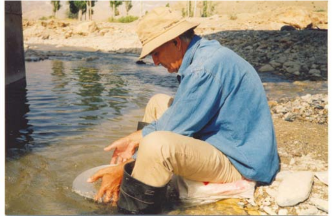
شکل ۵- تغلیظ نمونه‌های کانی سنگین به روش لاوک کوچک.
