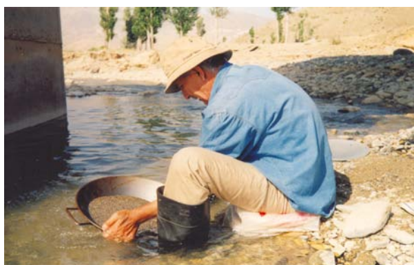
شکل ۴- تغلیظ نمونه‌های کانی سنگین به روش لاوک بزرگ.
