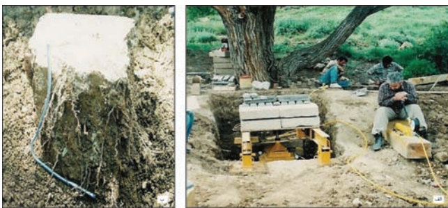
شکل ۳- الف) آزمایش در حال اجرا در ایستگاه میناوند، ب) اندازه گیری ریشه‌های بلوک خاک در پایان آزمایش
