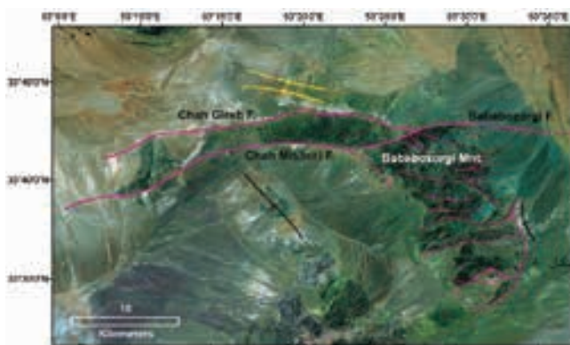
شکل ۸- گسل بابابزرگی و گسل‌های چاه گیره و چاه میشوری، اثر سطح محوری چین‌های پیش از نوژن به رنگ سیاه و اثر سطح محوری چین‌های پس از نوژن با رنگ زرد نمایش داده شده است.
