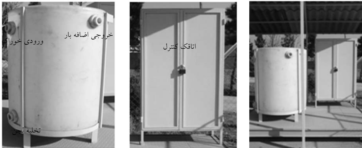
شکل ۳- تصویر مخزن هوادهی و اتاقک کنترل
