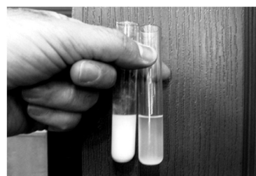
شکل ۶- نانوذرات اکسیدروی خالص (راست) و اصلاح شده (چپ) در اتانول خالص
