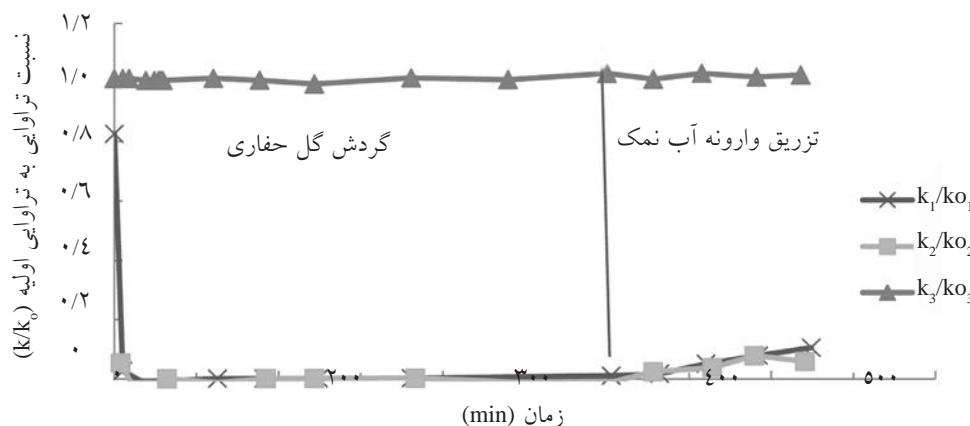
شکل ۱۴- میزان آسیب تراوایی شکاف بر حسب زمان (عرض شکاف 207 \mu\text{m} )
