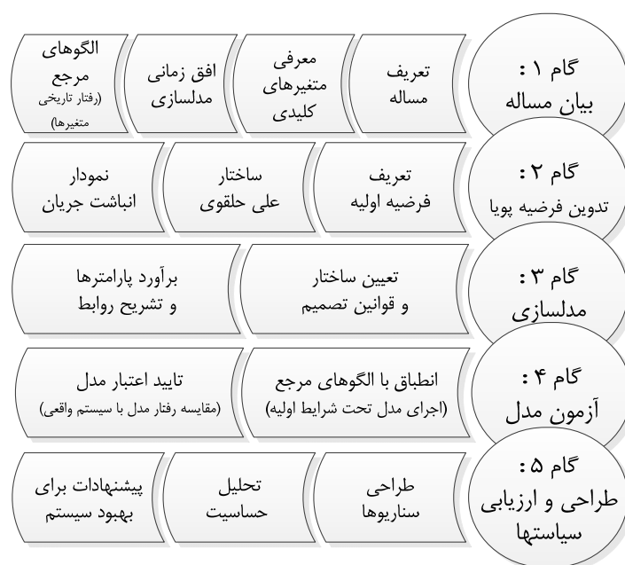
شکل ۱. نمودار روش پویایی‌های سیستمی ارائه‌شده در این مقاله بر اساس روش استرمن
