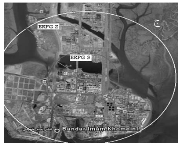
شکل ۱- حریم خطر مواجهه با مواد شیمیایی در محل مورد بررسی الف- برای غلظت ERPG ۳ (۱: اپی کلروهیدرین ۳۹۱ متر، ۲: هیدروژن کلراید ۳۵۱ متر، ۳: فنل ۲۷۵ متر، ۴: تولوئن ۲۴۰ متر، ۵: کلروبنزن ۱۲۱ متر) ب- غلظت ۲ ERPG (۱: اپی کلروهیدرین ۸۷۱ متر، ۲: هیدروژن کلراید ۸۵۱ متر، ۳: فنل ۵۵۱ متر، ۴: تولوئن ۴۳۸ متر، ۵: کلروبنزن ۱۷۱ متر). ج- برای کلر (۱: ۲ ERPG ۳۹۹۹ متر و ERPG ۳ ۱۳۳۹ متر)
