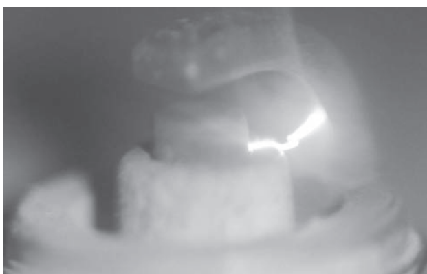
شکل ۱۶ جرقه جانبی در فشار ۸ بار
