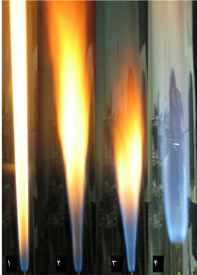
شکل ۲- تغییرات شکل شعله‌ی گاز طبیعی با سرعت تزریق سوخت و برای هوا با سرعت ۳ سانتیمتر بر ثانیه (۱) Re_{N,G}=1269 ، (۲) Re_{N,G}=1830 ، (۳) Re_{N,G}=2110 ، (۴) Re_{N,G}=2245
