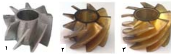
شکل ۱- پره‌های چرخاننده: (۱) ۳۰درجه، (۲) ۴۵درجه، (۳) ۶۰ درجه
