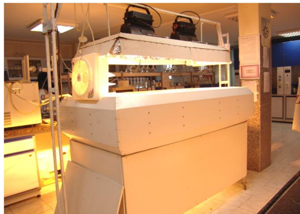
شکل ۱- نمایی از فتوبیوراکتور استفاده شده در این تحقیق
