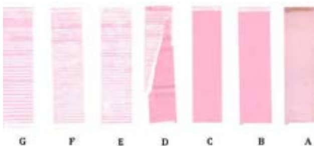
شکل ۸: مقایسه کنده شدن سطح کاغذهای شاهد و تیمار شده با روغن سنگین.
