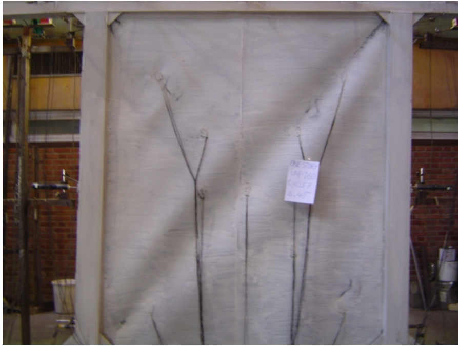
شکل (۳) : کمانش ورق در سیکل هجدهم
