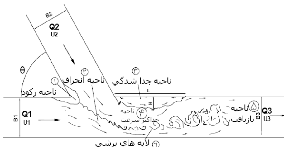
شکل (۱) - الگوی جریان در محل تلاقی کانال‌های روباز
