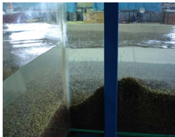
شکل (۴) - تعلیق ذرات کنده شده از چاله فرسایشی
