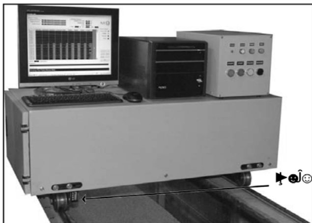
شکل ۲- نمایی از دستگاه برداشت پروفیل بستر لیزری
