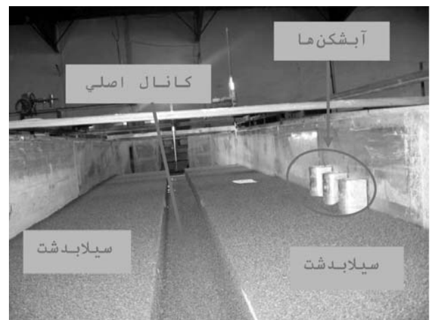
شکل ۵- نمایی از فلوم و آبشکن‌های ۱۰ سانتی متر دایره‌ای شکل
