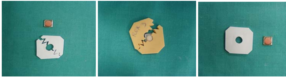
شکل ۱: آماده‌سازی نمونه‌ها برای پرس‌گذاری
