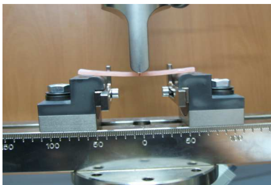
شکل ۱. نمونه در دستگاه تست یونیورسال
