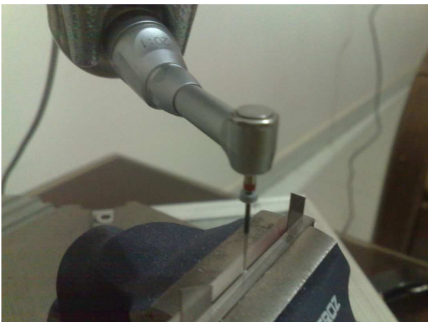
شکل ۳. نمای نزدیک از حرکت فایل چرخشی بر روی پلکسی‌گلاس
