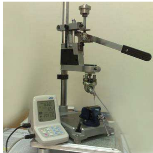
شکل ۲. سیستم طراحی شده جهت انجام برش
