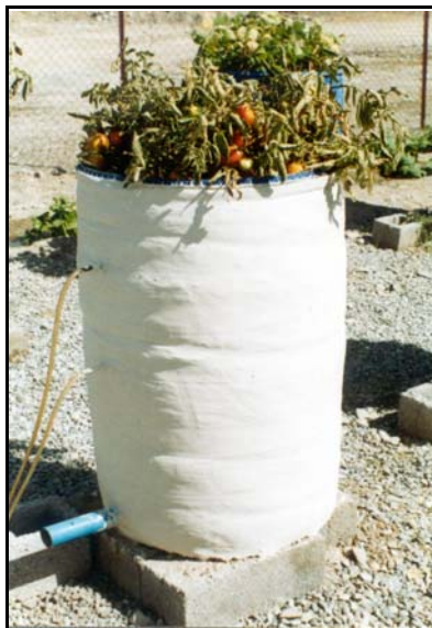
(شکل ۱) - لایسیمتر پس از نصب لوله‌های نمونه برداری زه‌آب از اعماق ۲۰ و ۴۵ سانتی‌متری
