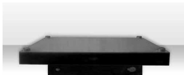
شکل ۳ - قالب استفاده شده برای ساخت دیواره‌های ساندویچی.
