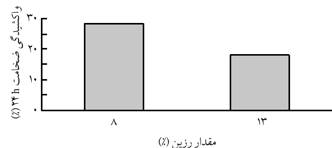
شکل ۱۲ - اثر مستقل مقدار رزین بر واکشیدگی ضخامت 24 h تخته‌های ساخته شده از رزین AESO.
