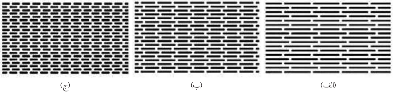
شکل ۸ - طرح کلی مدل‌ها برای نسبت‌های منظر مختلف: (الف) ۵۰، (ب) ۱۰۰ و (ج) ۱۵۰.
