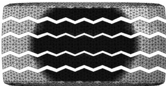
شکل ۹- ناحیه جاپای پیش بینی شده تایر با زمین به وسیله مدل جزئی.
