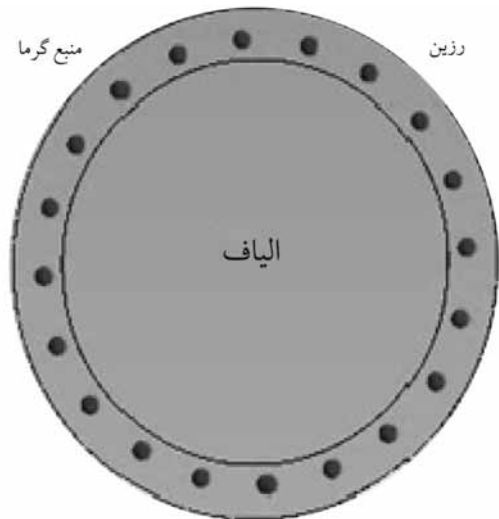
شکل ۵- هندسه قطعه نشان دهنده تک رشته، رزین و چشمه‌های گرمایی.
