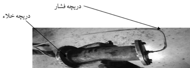
شکل ۳ - محفظه فولادی به همراه دریچه‌های خلاء و فشار.
