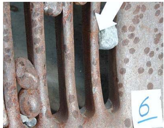
شکل ۱۳: شکست صفحات جداکننده سوراخ‌ها در شبکه.
