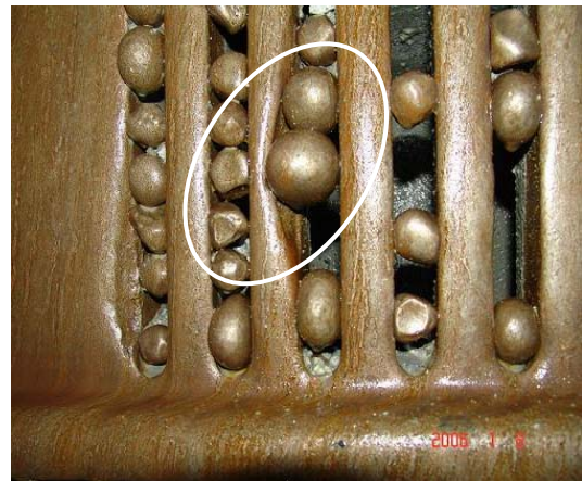
شکل ۱۴: مراحل اولیه ایجاد شکست در صفحات شبکه‌ها.
