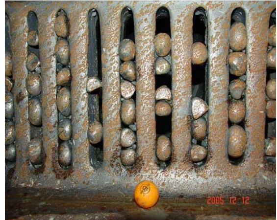
شکل ۱۲: تصویری از شکاف‌های پر شده با گلوله‌ها.
