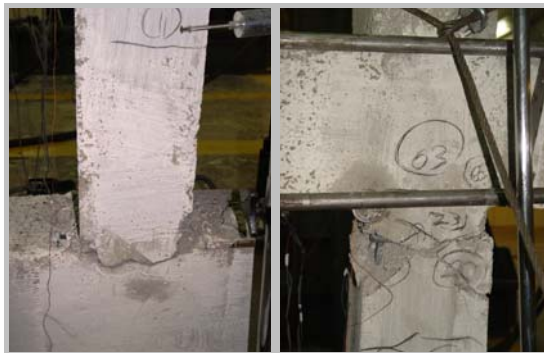
شکل ۹: مفاصل پلاستیک ایجاد شده در ی قاب بدون میان قاب، الف) بالای ستون، ب) پایین ستون.
