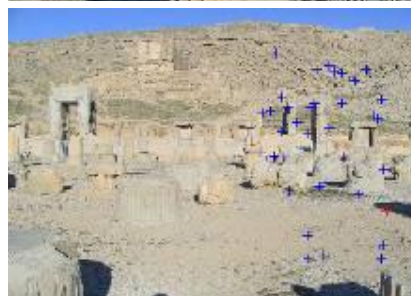
شکل ۸: انجام تناظریابی برای مناطق باستانی برای تصاویر اخذ شده به صورت متوالی از یک ایستگاه با پوشش ۴۰ درصدی.
