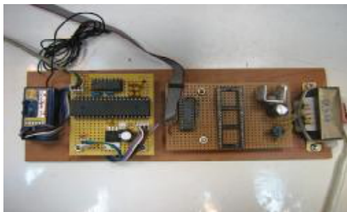
شکل ۱۱: برد رابط کامپیوتر و رادیو کنترلر.
