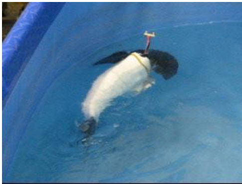
شکل ۲۲: اعمال کنترلر روی میکرو زبردربایی و پایداری حرکت آن در یک باند ۲۰ سانتی‌متری و با فاصله ۱۰ سانتی از دیواره.
