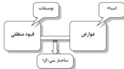
شکل ۲- ایجاد یک ساختار شیء‌گرا با در نظر گرفتن عوارض به صورت اشیاء و قیود منطقی به صورت توصیفات مربوط به آنها
