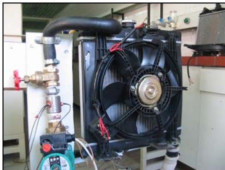
شکل ۴- فن نصب شده روی سکوی آزمون رادیاتور
