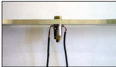
شکل ۳- نحوه قرارگرفتن بوش بین مهره و ورق آلومینیومی
