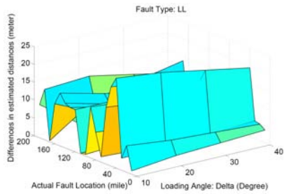
شکل ۱۲- تاثیر زاویه بارگیری خط (خطای خط به خط)
