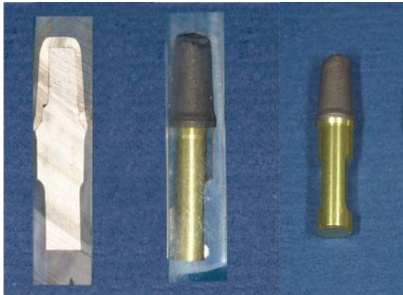
شکل ۵- از راست به چپ: فریم بر روی آنالوگ نشانده شده، در آکريل شفاف قرار داده، سپس برش داده شده است.
