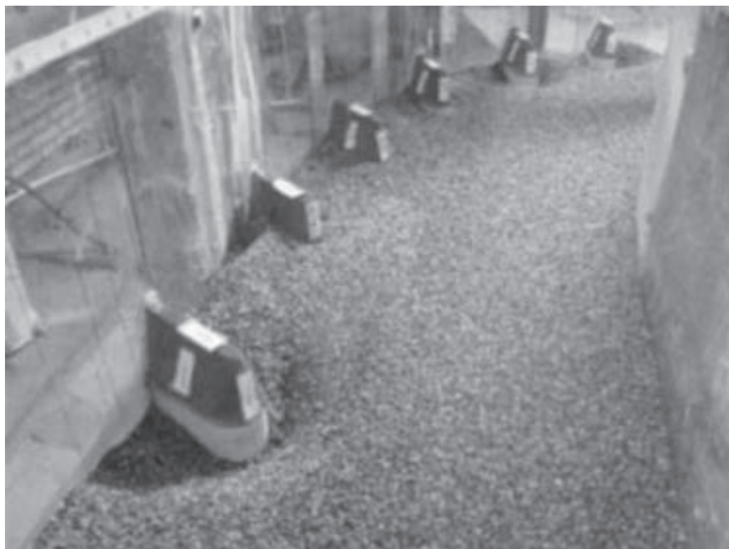
شکل ۵- نمایی از بستر رسوبی (S=۳L, Fr=۰/۲۵)
