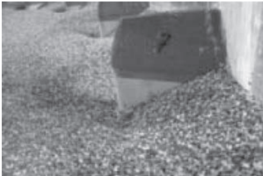
شکل ۱۰ - نمایی از بستر رسوبی اطراف سازه ۷ در آزمایش (S= ۴L, Fr=۰/۲۵)
