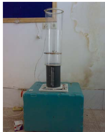
شکل ۱- دستگاه ساخته شده جهت اندازه‌گیری سرعت شناوری
