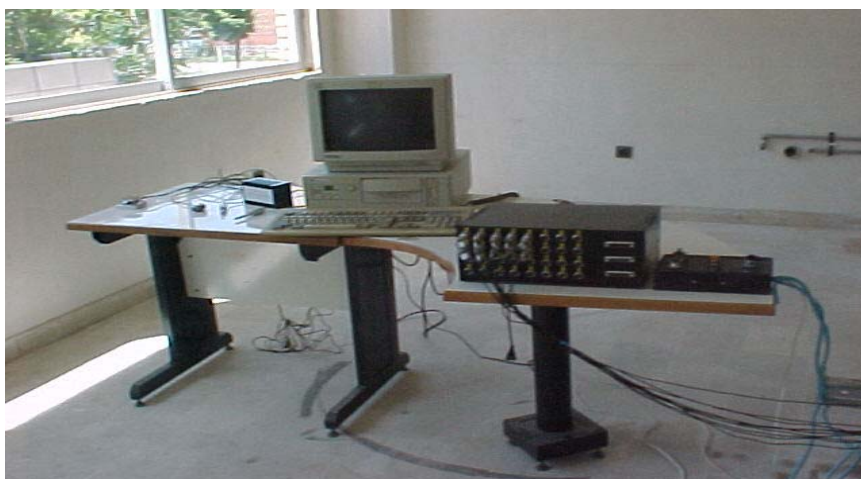
شکل ۴: تصویری از سیستم قرائت و ضبط داده ها شامل دیتا لاگر، کامپیوتر، ترانسدیوسرهای تغییر مکان، نیرو و تنش.
