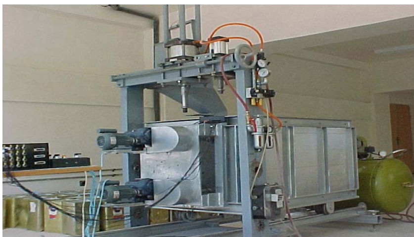
شکل ۳: تصویری از سیستم بارگذاری طراحی شده جهت اعمال سربارهای استاتیکی و سیکیلی به خاک پشت دیوار حائل.
