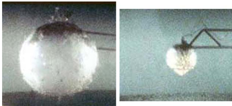
شکل ۱: راست) تولد حباب حاصل از انفجار. چپ) حباب پر فشار در حال انبساط.
