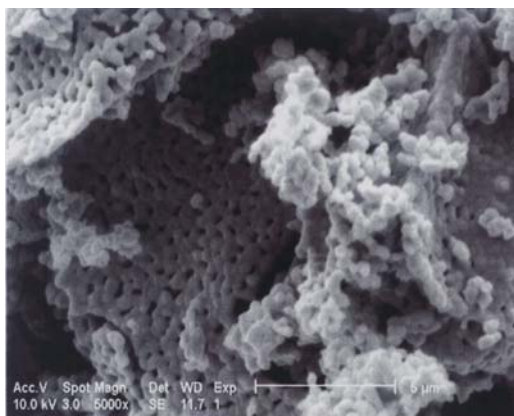
شکل ۲: SEM مربوط به کاتالیست LC.
