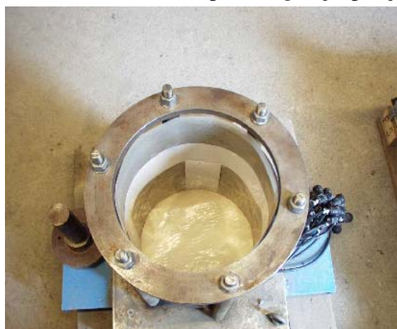
شکل ۷: نحوه قرارگیری فیلم حساس به فشار بالا در داخل دستگاه محفظه حلقوی [۴].
