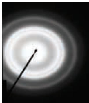
شکل ۳: طرح پراش اشعه X توسط فیلم \text{CoCrPt}(\text{Al}_2\text{O}_3) حاوی ۱۳٪ \text{Al}_2\text{O}_3 قبل از عملیات حرارتی.
