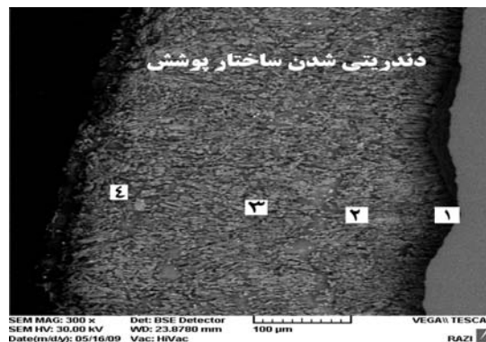
شکل (۴): ریز ساختار پوشش فولاد زنگ نزن ۳۱۶ درون روی مذاب ۱ غوطه ور شده به مدت ۱۲۰ ساعت در دمای 458^{\circ}\text{C} (با استفاده از میکروسکوپ الکترونی)
