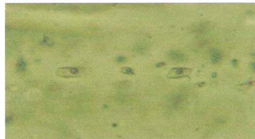
شکل ۳. سیال غنی از بخار (اندازه متوسط حفرات ۱۲ میکرون)
