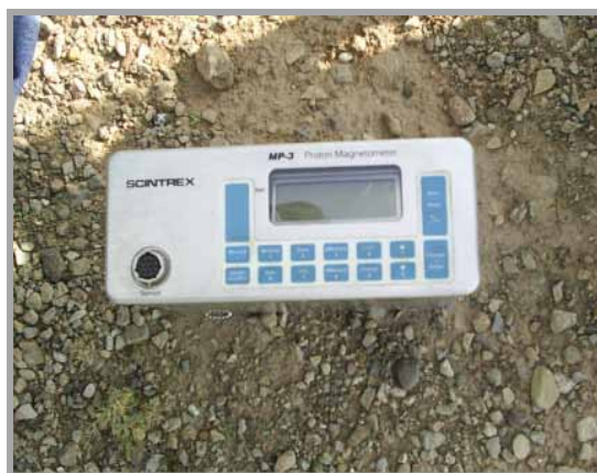
شکل ۵: مغناطیس سنج پروتون مدل MP3 ساخت شرکت Scintrex کانادا
