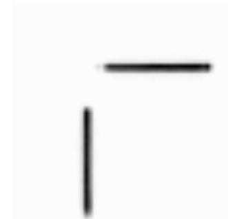
شکل شماره ۱- تصویر دو چشمه خطی (لوله مویینه) هر یک حاوی حدود 150 \mu Ci از پرتو داروی Tc^{99m} که در دو راستای کاملاً عمود بر یکدیگر و موازی با محور های افقی و عمودی در مرکز کلیماتور قرار داده شدند
